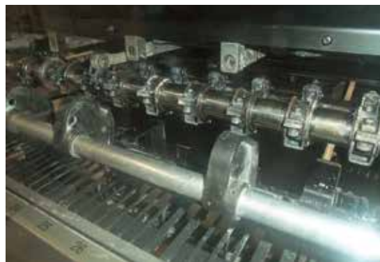
14年使っている菊全判8色機のデリバリ部。多くの印刷会社で、真っ白になっている部分だ。清掃をこまめにやっているといっても、ここまできれいなデリバリは20年記者は見たことがなかった
